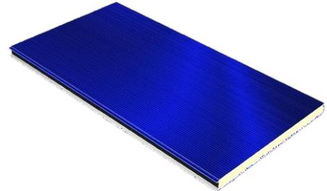
**Wärmedämmendes Wandpaneel „POLAR“ mit sichtbarer Befestigung mit Seiten (oben und unten) aus verzinktem Stahlblech mit galvanischem Schutz (PES, PVDF..) mit Kern aus PUR-Polyurethanschaum mit einer Dicke von 100 mm.**
